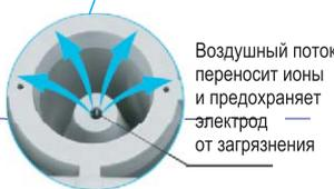
Воздушный поток переносит ионы и предохраняет электрод от загрязнения
