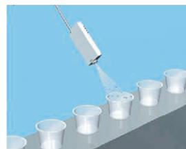
Удаляет пыль с внутренней поверхности пластиковых стаканов
