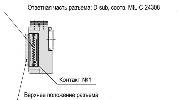
**Размеры: блок распределителей SJ2000, подключение шлейфом**
