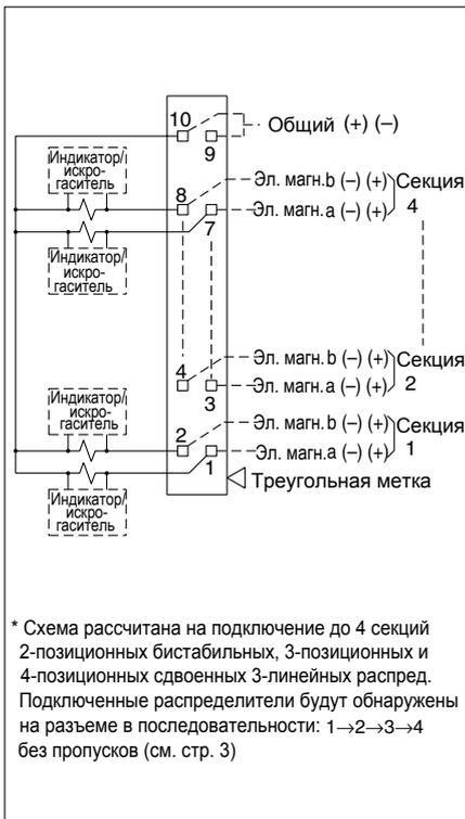
\* Схема рассчитана на подключение до 4 секций 2-позиционных бистабильных, 3-позиционных и 4-позиционных сдвоенных 3-линейных распред. Подключенные распределители будут обнаружены на разъеме в последовательности: 1→2→3→4 без пропусков (см. стр. 3)
