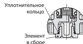
**Продольное сечение порта EXH в сборе со встроенным пневмоглушителем**
